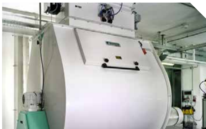
Speciální mixér pro rychlou a účinnou homogenizaci sypkých směsí
